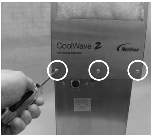
Obr. 6-12 Demontáž horného krytu ventilátora
