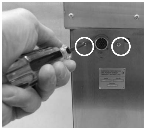
Demontáž skrutiek na zásuvke unicable
