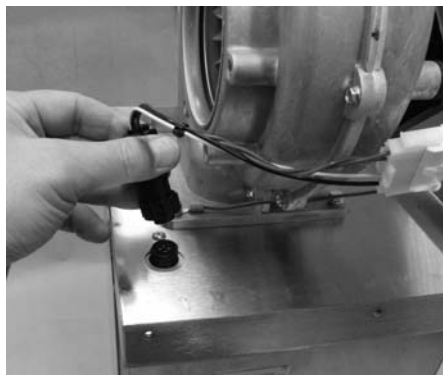
Demontáž zástrčky ventilátora
