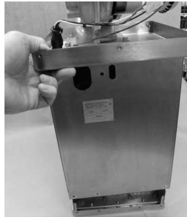
Figura 6-14 Rimozione della copertura
