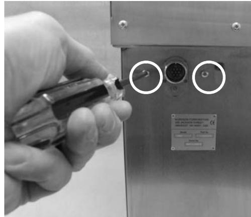
Figura 6-12 Smontaggio del coperchio del soffiante
