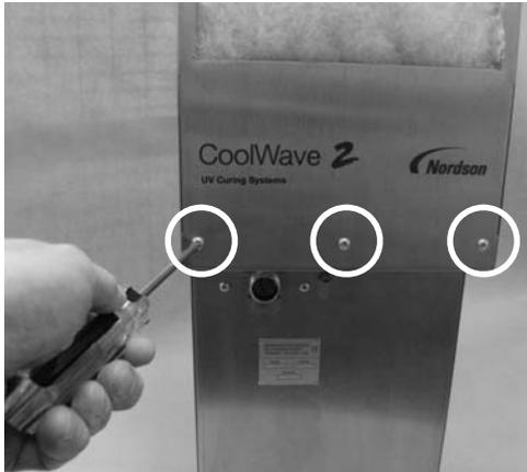
**Rimozione delle viti della presa Unicable**
