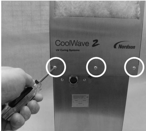
**Schrauben an Unicable-Buchse entfernen**
