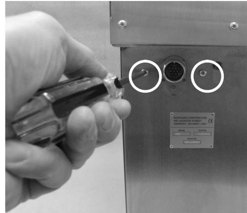
Abbildung 6-12 Entfernen der oberen Gebläseabdeckung
