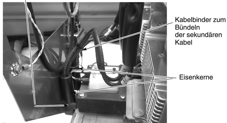
Abbildung 6-22 Anbringen von Kabelbindern an sekundären Kabeln
