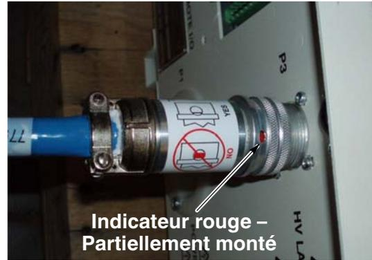
Figure 3-4 Connecteur Unicable partiellement monté
