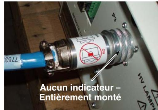
Figure 3-5 Connecteur Unicable entièrement monté
