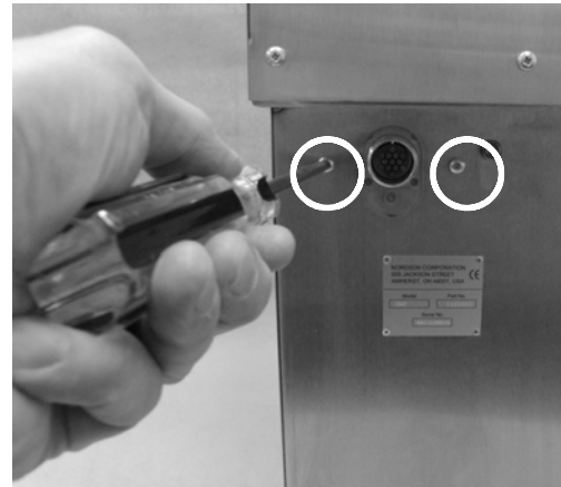
ユニケーブルソケットでボルトを除去
