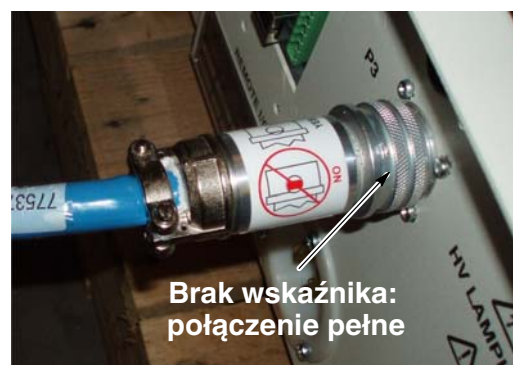
Rysunek 3-10 Złącze dokręcone do oporu
