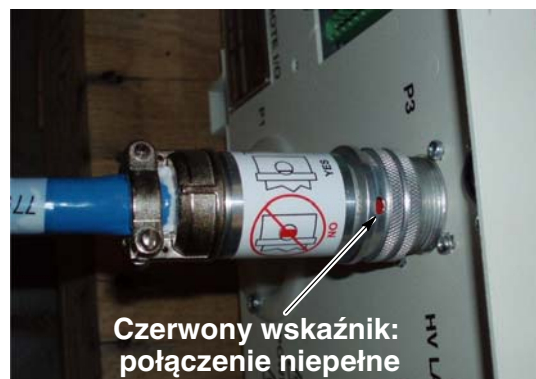
Rysunek 3-9 Złącze niedokręcone do oporu
