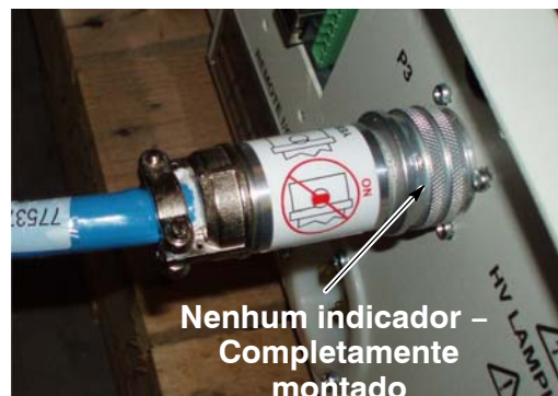
Figura 3-10 Conector de cabo unifilar completamente montado
