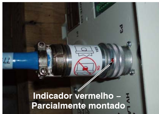
Figura 3-5 Conector de cabo unifilar parcialmente montado
