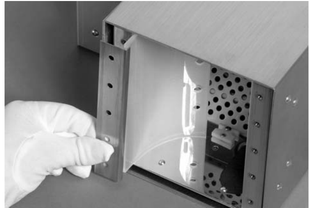
Figura 4-7 Colocação do suporte de fixação para luz focada
