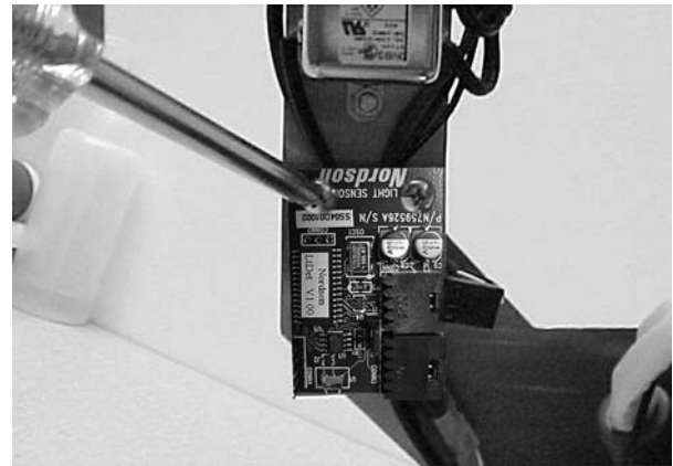
Bild 4-15 Byte av kretskort för ljusdetektor
