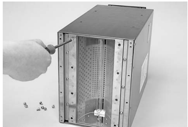
Bild 4-1 Demontering av RF skärm
