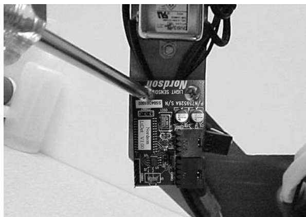
Abb. 4-15 Austausch der Lichtsensorplatine
