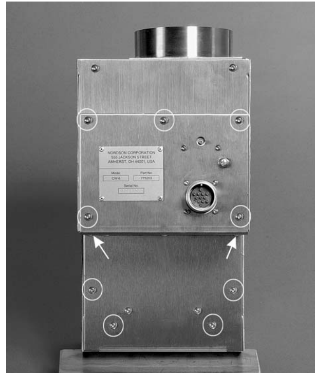
Abb. 4-10 Abnehmen der Lampenkopfabdeckung
