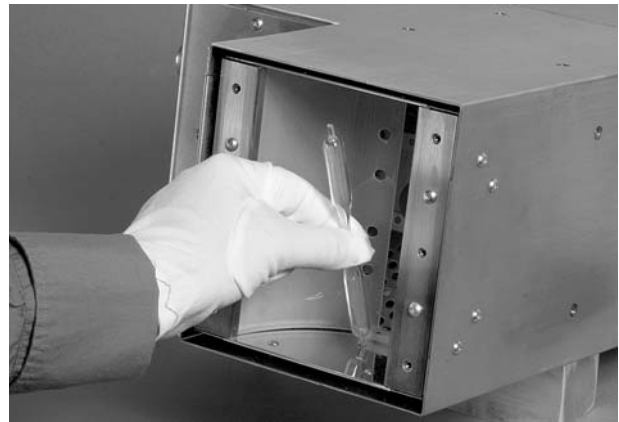
Abb. 4-2 Austausch der Lampenkolben
