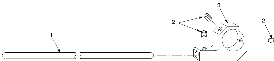
Rys. 7-5 Zestaw kolektora jonów z mocowaniem Shur-Lok
