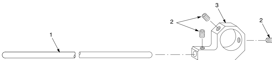
Bild 7-5 Sats med Shur-Lok jonfångarfäste
