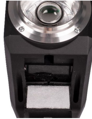
Рисунок 53: Замена входного фильтра
