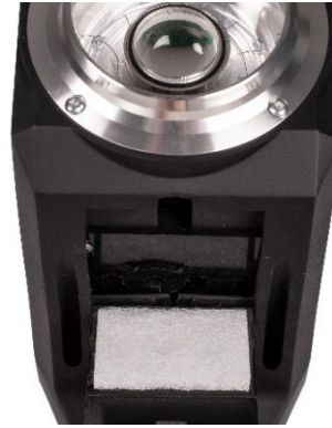
Figura 52: Substituição do filtro de entrada
