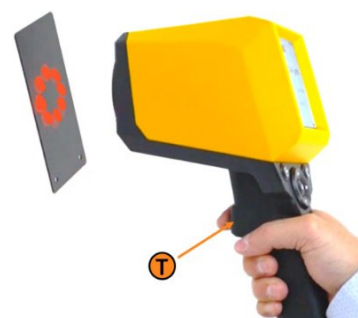
Figure 40: リファレンス/キャリブレーション測定
