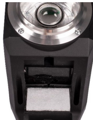
Figure 54: 入口フィルターの交換
