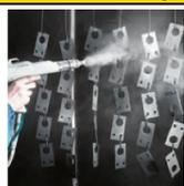
Grazie al controllo della misurazione dello spessore del rivestimento con Flex, è possibile risparmiare fino al 30% della quantità di polvere. La misurazione all'inizio del processo prima della polimerizzazione consente inoltre di risparmiare tempo e riduce i tassi di rilavorazione.
