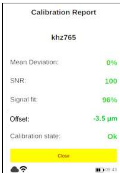
Informe de calibración para una calibración offset, que muestra el valor offset (en este ejemplo -3,5 µm). Como regla general, el valor absoluto no debe ser mayor que el espesor mínimo del recubrimiento utilizado en la aplicación. Se permiten valores offset positivos y negativos.
