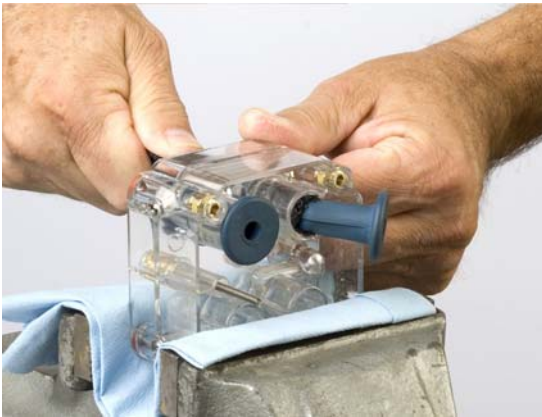
Figura 13 Tragerea supapei de efilare în corpul supapei
