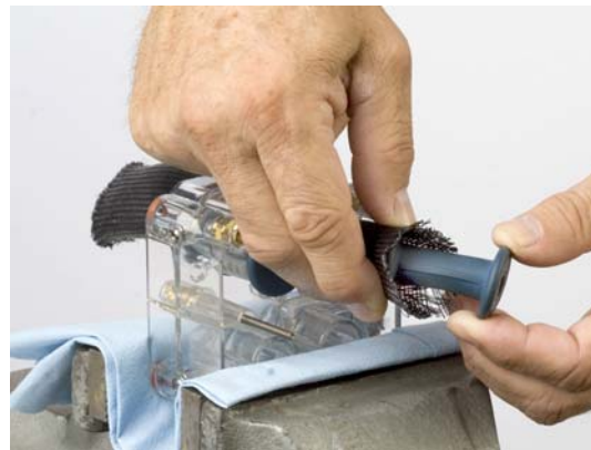
Figura 11 Introducerea supapei de efilare în dispozitivul supapei de efilare a pompei
