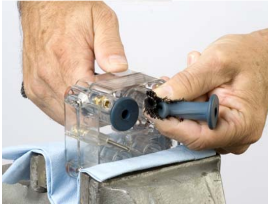
Figura 12 Efilarea plată a flanșei Up a supapei de efilare
