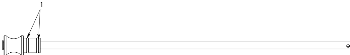
Rysunek 10 Rura ssąca i adapter pompy do do zasobnika Encore HD 50-funtowego
