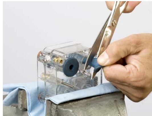
Figura 10 Extracción de las válvulas peristálticas
