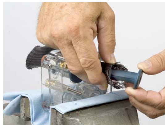
Figura 11 Inserción de la válvula peristáltica en la herramienta para válvulas peristálticas de bomba
