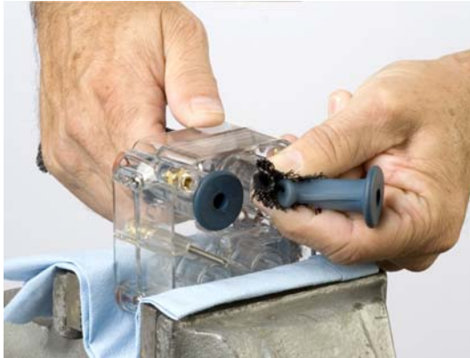
Figura 12 Apretar el saliente superior de la válvula peristáltica
