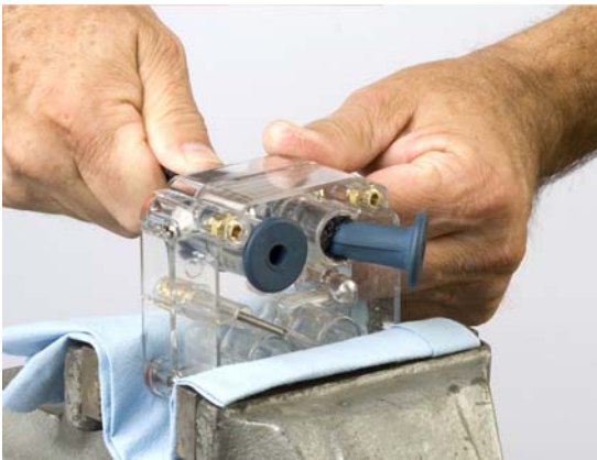
Figura 13 Inserción de la válvula peristáltica en el cuerpo de válvulas
