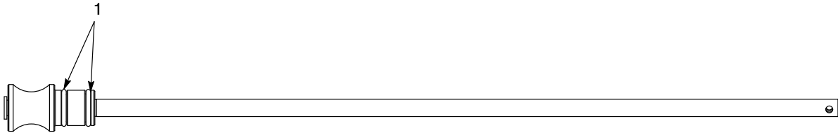
Afbeelding 10 Aanzuigbuis en pompadapter voor 23 kg Encore HD hoppers
