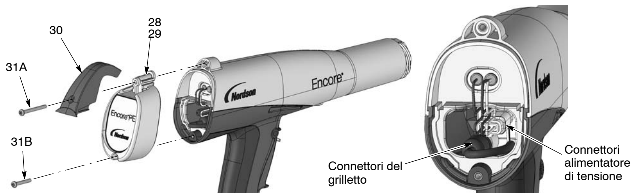
Figura 6-1 Smontaggio della pistola
