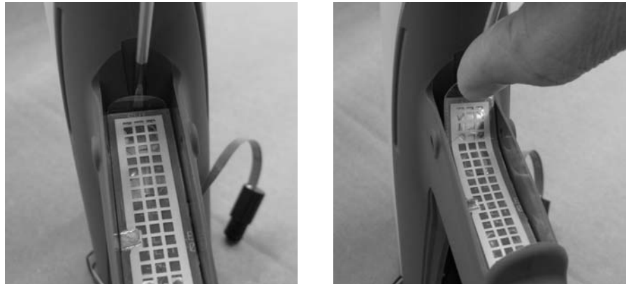
Figura 6-9 Rimozione dell'interruttore del grilletto dall'impugnatura
