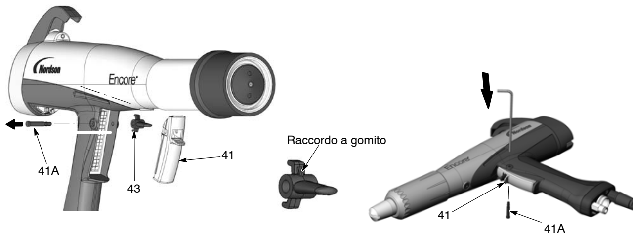
Figura 6-8 Rimozione dell'asse e del grilletto dall'impugnatura
