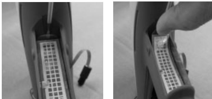
图 6 - 8 从手柄上拆下触发器开关
