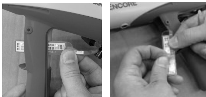
图 6 - 9 安装触发器开关 - 步骤 1 和 2
