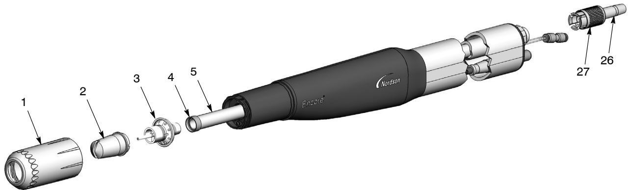
图 16 粉末磨损零件更换
