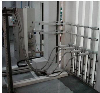
Ábra 4-3 Szórópisztolyok öblítési helyzetben
