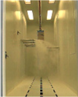
图 4 - 1 ColorMax 工程粉末喷涂室正在运行
