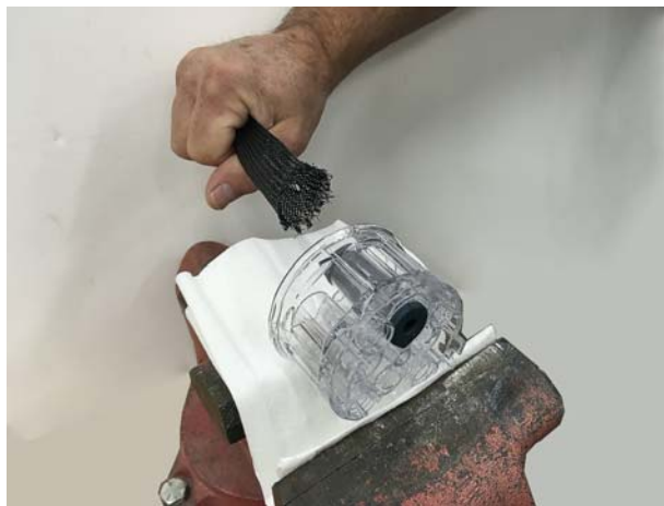
Ábra 29 Tömlőszelep behúzása a szeleptestbe
