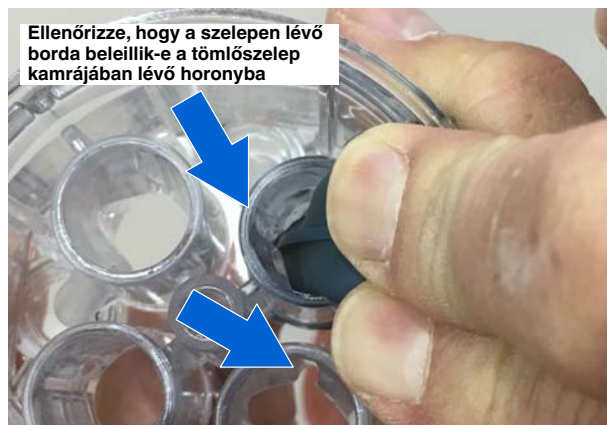
Ábra 30 A bordázat és a horony illeszkedésének ellenőrzése
