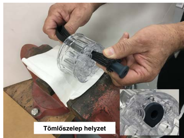
Ábra 27 A tömlőszelep testének illesztése a bevezető szerszámba
