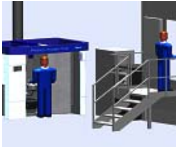
Figura 4-7 La cabina de ingeniería ColorMax y centro de alimentación de polvo están listos para el lote nuevo
