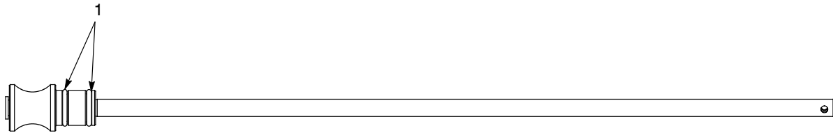
Рис. 10 Всасывающая трубка и переходник насоса для 50-фунтовых питателей Encore HD
