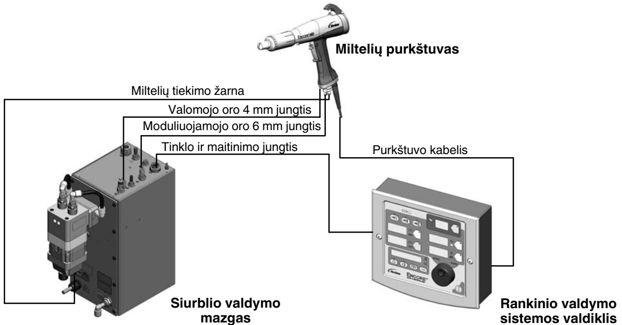
Paveikslėlis 3-2 Tipinė HD sistemos schema
