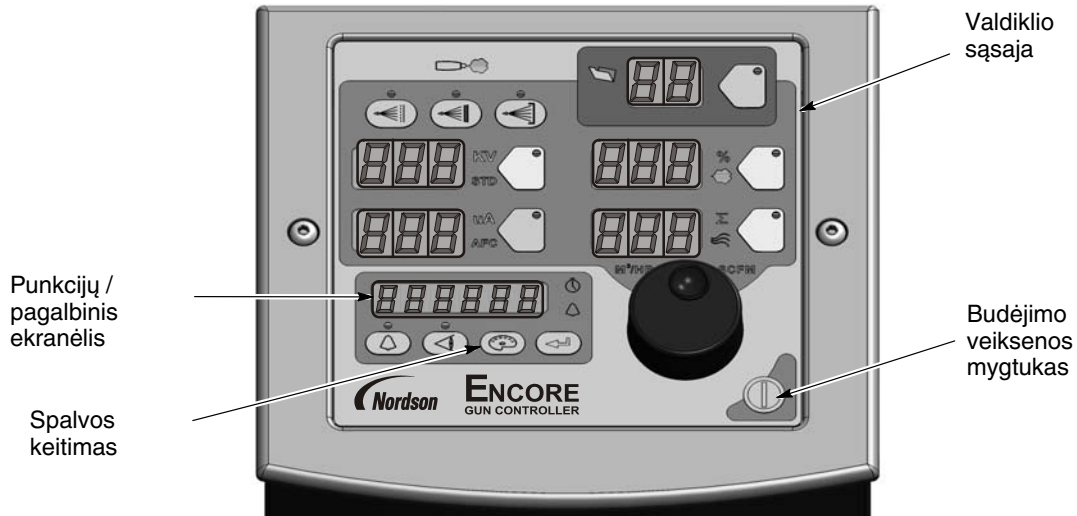
Paveikslėlis 4-1 Sistemos valdymo elementai - Pavaizduota mobilioji sistema
