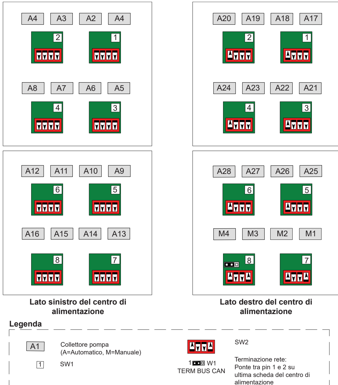
Figura 5 Tipico layout del pannello pompe
