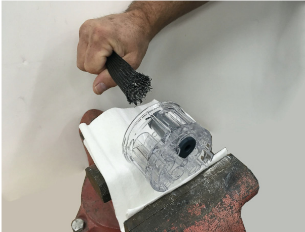
Şekil 32 Esnek Valfin Valf Gövdesinin İçine Çekilmesi
