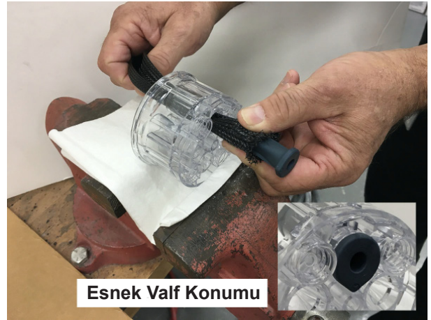
Şekil 30 Esnek Valfin Yerleştirme Aletine Takılması
