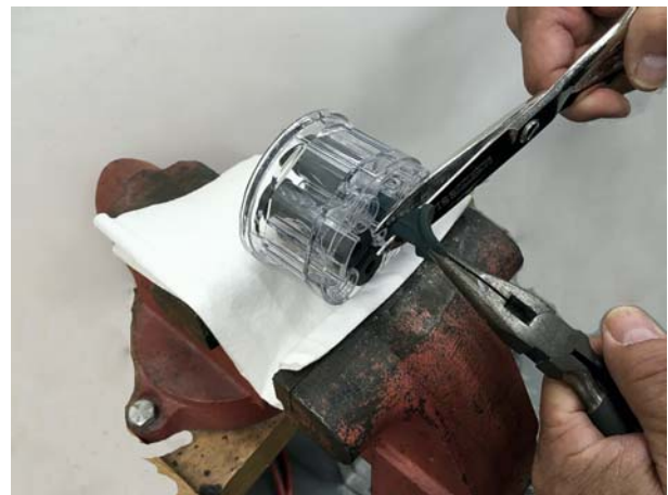
Bild 26 Demontering av strypventil
