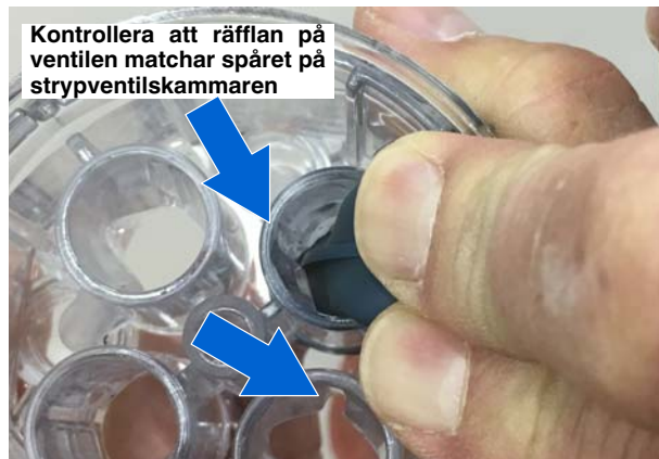
Bild 30 Kontroll av inriktning mellan räfflor och spår
