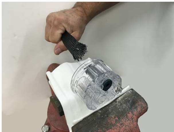
Bild 29 Indragning av strypventilen i ventilkroppen.
