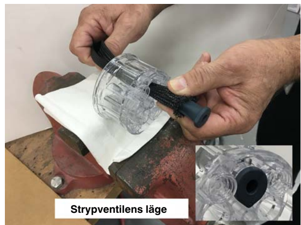
Bild 27 Påsättning av strypventil på installationsverktyget.
