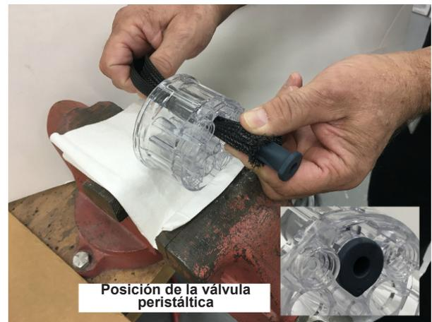
Figura 30 Introducción de la válvula peristáltica en la herramienta de inserción
