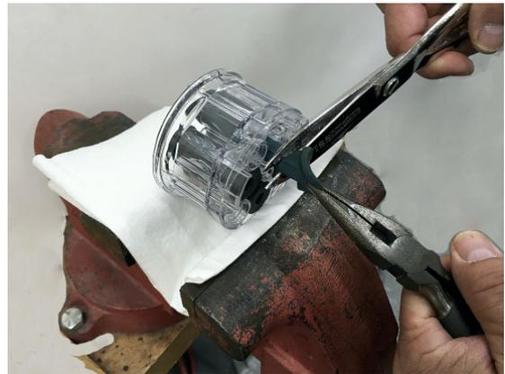
Figura 29 Extracción de las válvulas peristálticas
