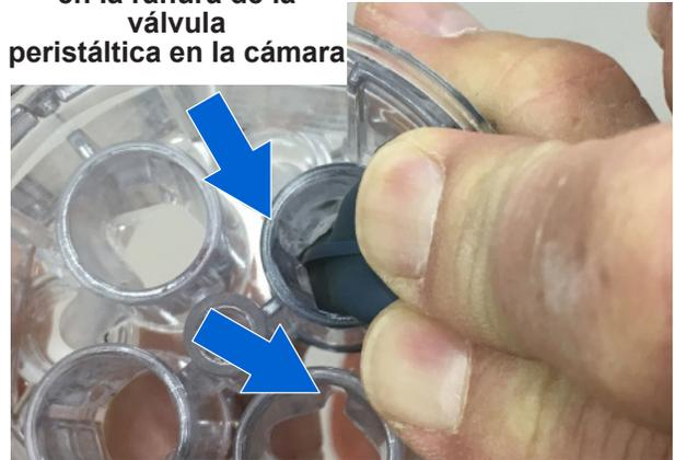
Figura 33 Comprobación de la alineación de los nervios y las ranuras
