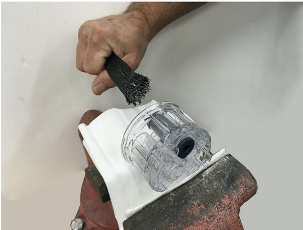
Figura 32 Inserción de la válvula peristáltica en el cuerpo de válvulas
