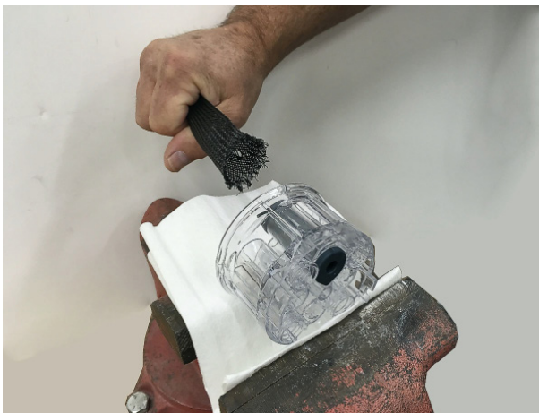
Slika 32 Poteg ščipalnega ventila v ohišje ventilov
