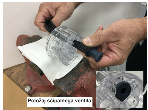
Slika 30 Vstavljanje ščipalnega ventila v orodje za vstavljanje
