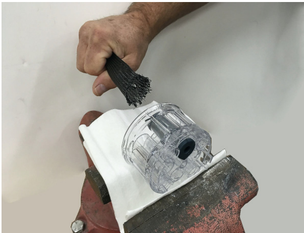
Рис. 32 Втягивание пережимного клапана в корпус клапанов
