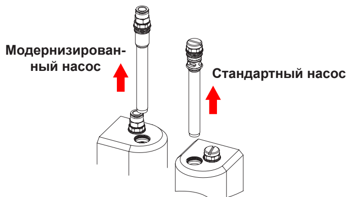
Рис. 15 Освобождение трубок псевдооживления
