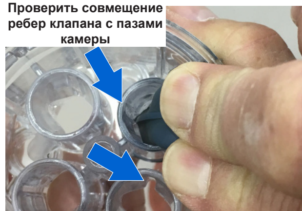
Рис. 33 Проверка совмещения ребра и паза
