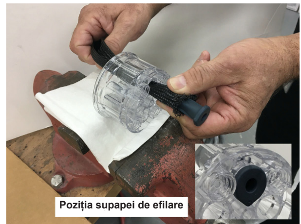
Figura 30 Introducerea supapei de efilare în dispozitivul de inserție
