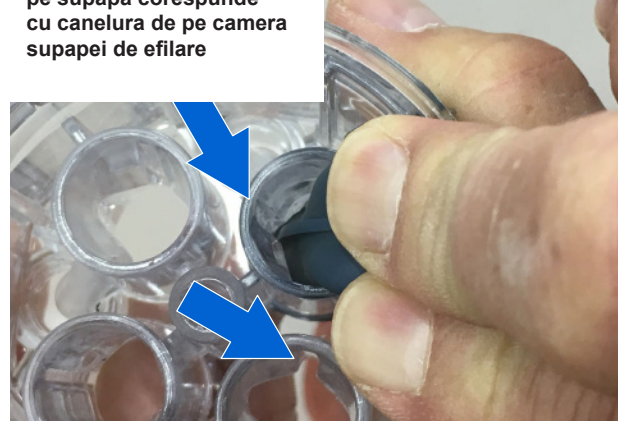
Figura 33 Verificarea alinierii nervurilor și a canelurilor
