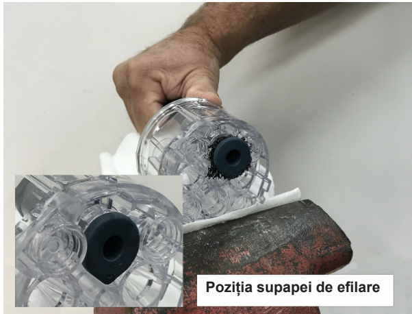
Figura 31 Trageți tubul de inserție prin cameră
