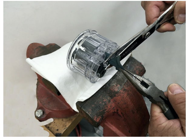
Figura 29 Îndepărtarea supapei de efilare
