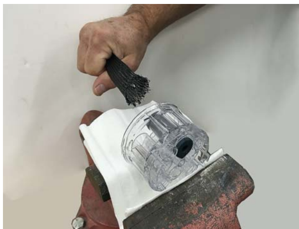
Figura 29 Puxar a válvula de manga flexível para dentro do corpo da válvula
