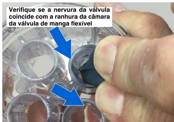
Figura 30 Verificação do alinhamento da nervura e da ranhura
