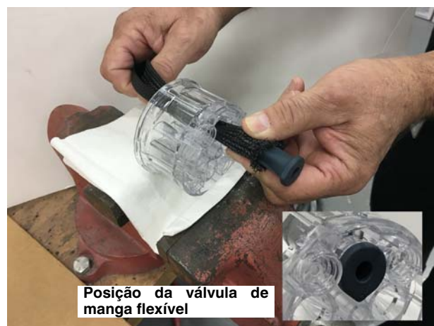
Figura 27 Inserção da válvula de manga flexível na ferramenta de inserção
