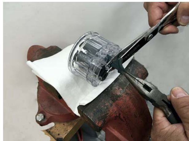
Figura 26 Remoção da válvula de manga flexível
