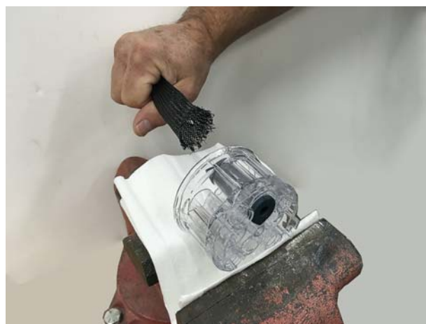
図 29 ピンチバルブをバルブ本体に引きこみ
