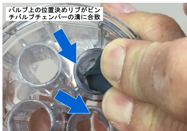
図 30 リブと溝の整列を確認
