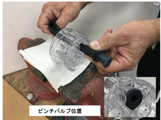
図 27 ピンチバルブを挿入ツールに挿入
