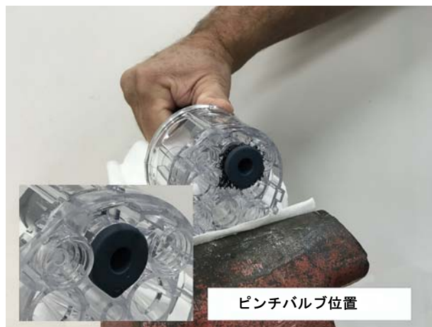
図 28 挿入ツールをチェンバーを通して引っ張ります
