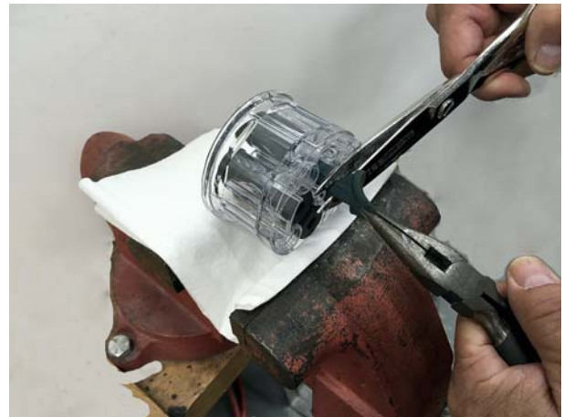
図 26 ピンチバルブの取り外し
