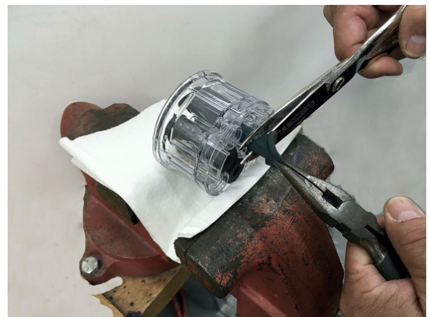
Figura 29 Smontaggio della valvola a manicotto
