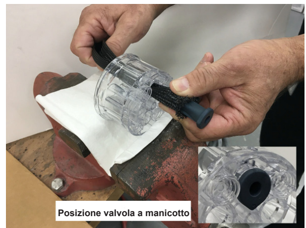
Figura 30 Inserimento della valvola a manicotto nell'utensile di inserimento
