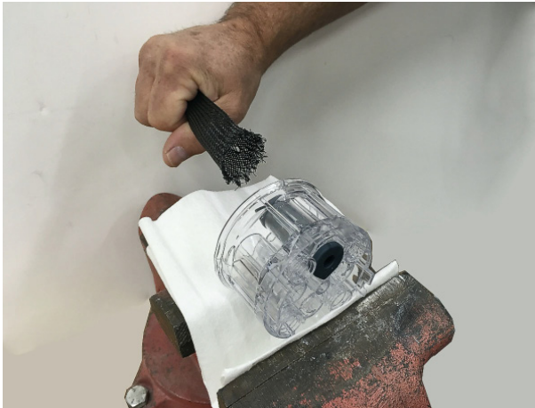
Figura 32 La valvola a manicotto viene tirata nel corpo valvola
