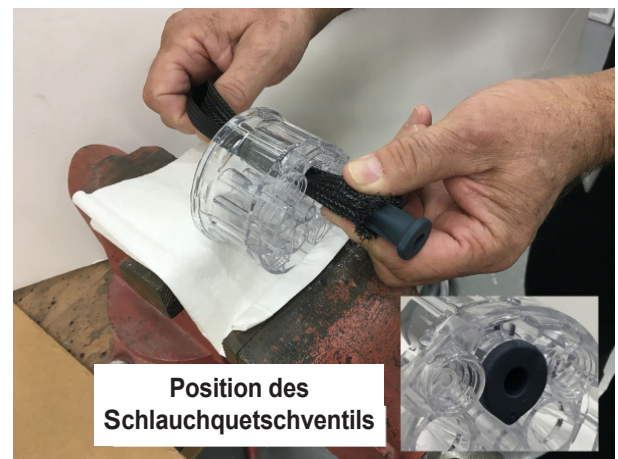
Abbildung 30 Einführen des Schlauchquetschventils in das Einsetzwerkzeug
