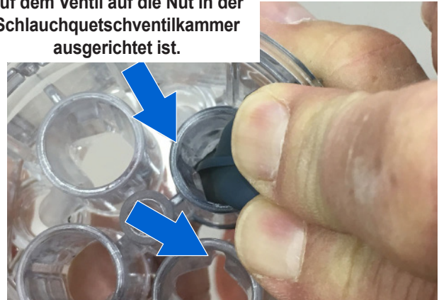
Abbildung 33 Ausrichtung von Rippen und Nuten überprüfen
