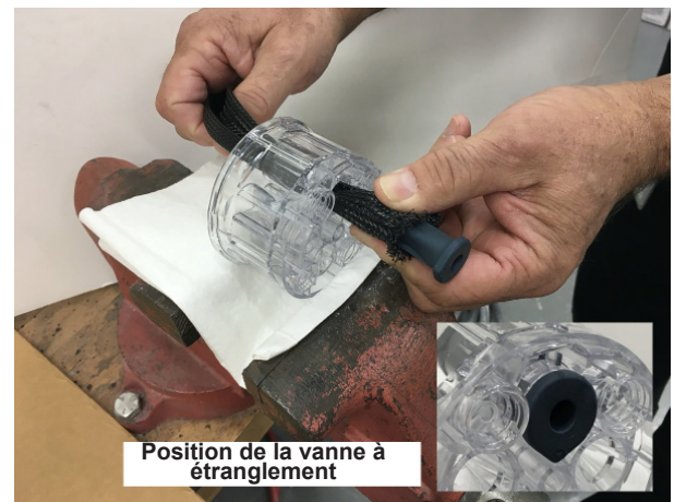
Figure 30 Insertion de la vanne à étranglement dans l'outil d'insertion
