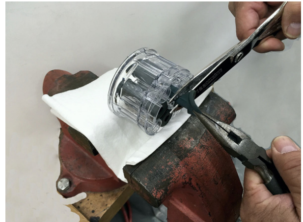
Figure 29 Dépose de la vanne à étranglement
