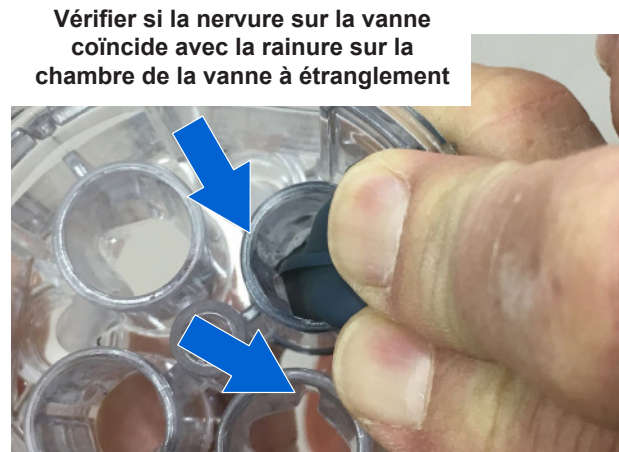
Figure 33 Contrôle de l'alignement des rainures et des nervures
