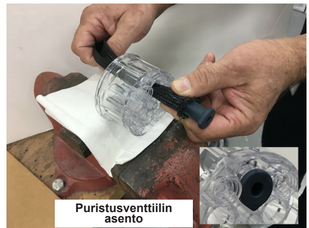
Kuva 30 Puristusventtiilin asettaminen asennustyökaluun
