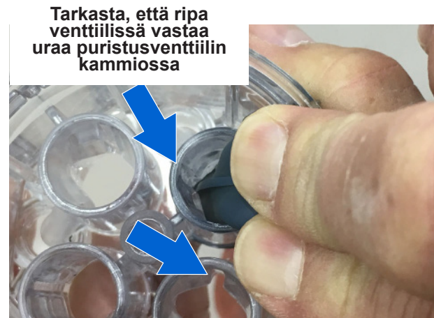
Kuva 33 Ripojen ja urien kohdistuksen tarkastus
