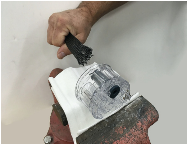
Afbeelding 32 Pinch valve in klephuis trekken
