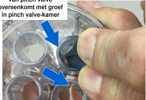
Afbeelding 33 Uitlijning van rand en groef controleren
