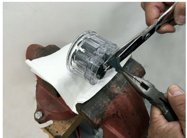
Afbeelding 29 Pinch valve verwijderen
