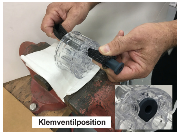
Figur 30 Isætning af klemventil i isætningsværktøj
