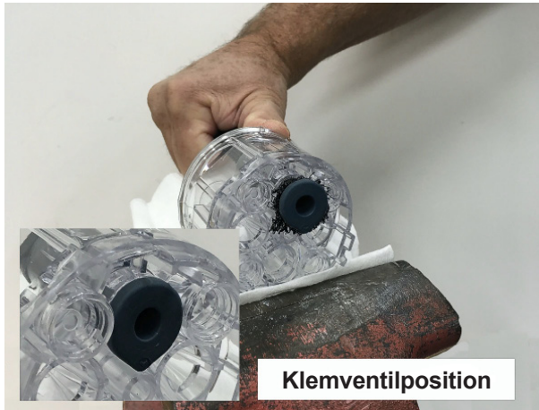
Figur 31 Træk isætningsslangen gennem kammeret
