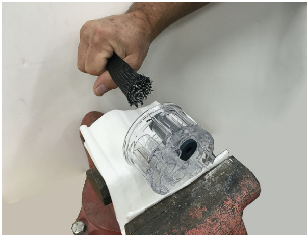
Figur 32 Trækker klemventil ind i ventilhus
