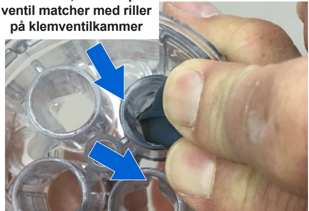
Figur 33 Kontrol af justering for ribber og riller
