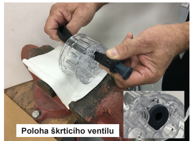
Obrázek 30 Vložení škrticího ventilu do zasouvacího nástroje
