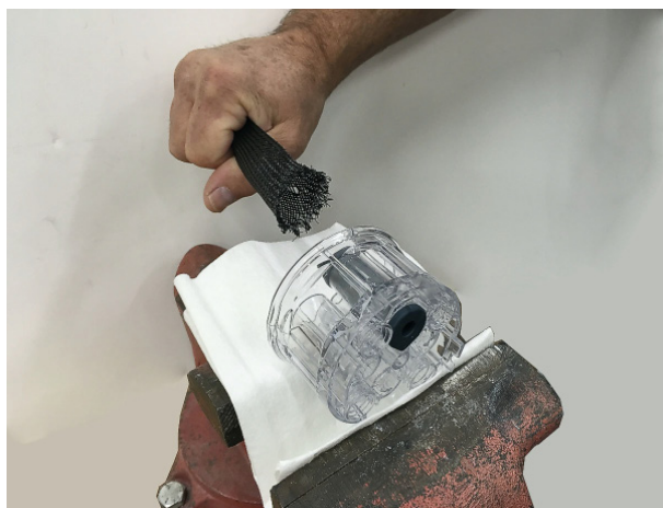
Obrázek 32 Zatažení škrticího ventilu do tělesa ventilů
