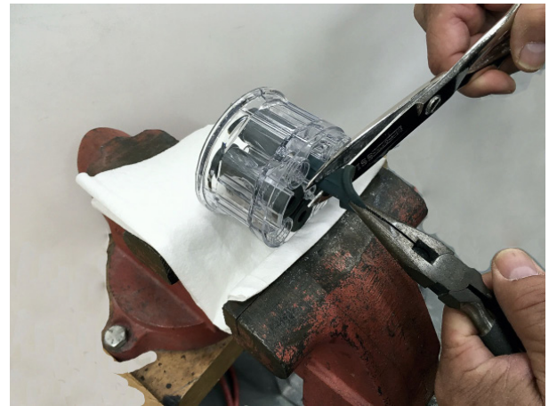
Obrázek 29 Demontáž škrticího ventilu
