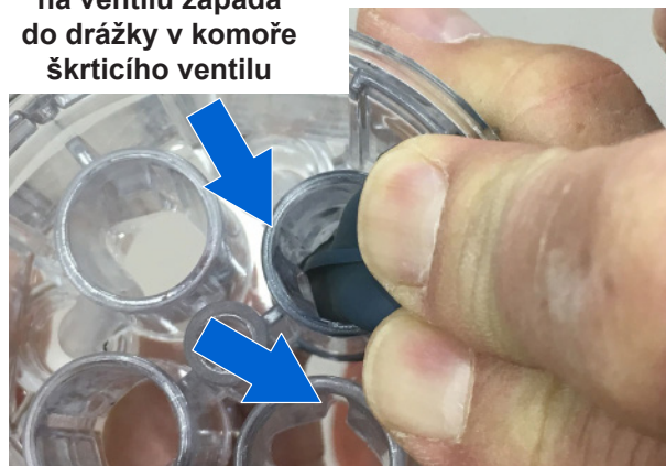
Obrázek 33 Kontrola zarovnání žebra a drážky
