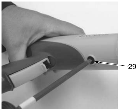
Ábra 6-3 Pisztolytest eltávolítása a fogantyúról
