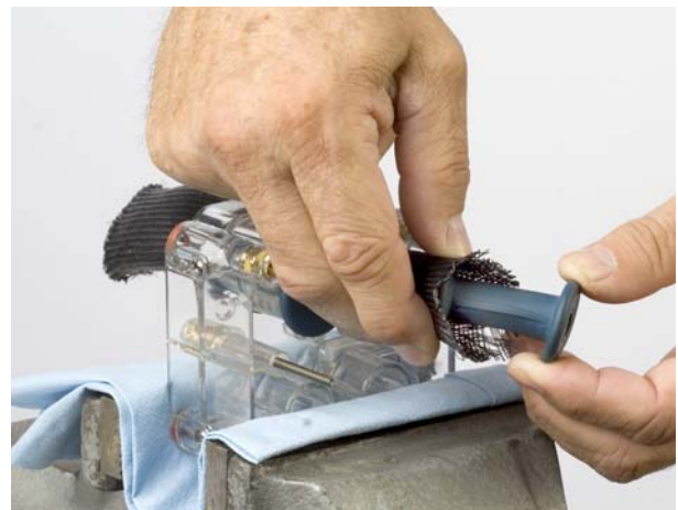
Ábra 13 A tömlőszelep testének illesztése a bevezető szerszámába
