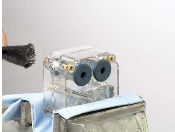
Ábra 16 Tömlőszelep áthúzása a szeleptesten
