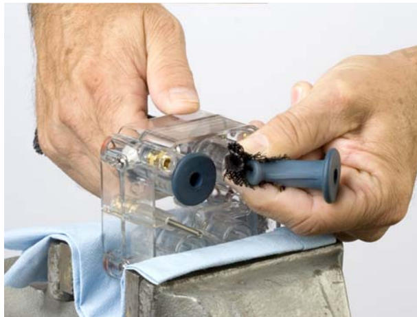
Ábra 14 Lapos tömlőszelep felső karimájának elszorítása
