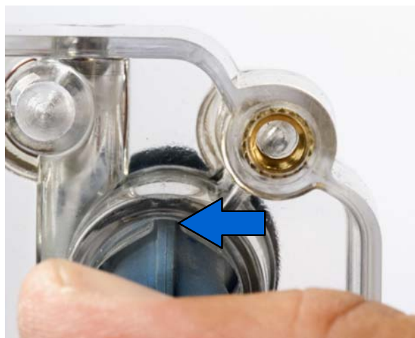
Ábra 17 A bordázat és a horony illeszkedésének ellenőrzése
