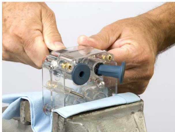
Ábra 15 Tömlőszelep behúzása a szeleptestbe
