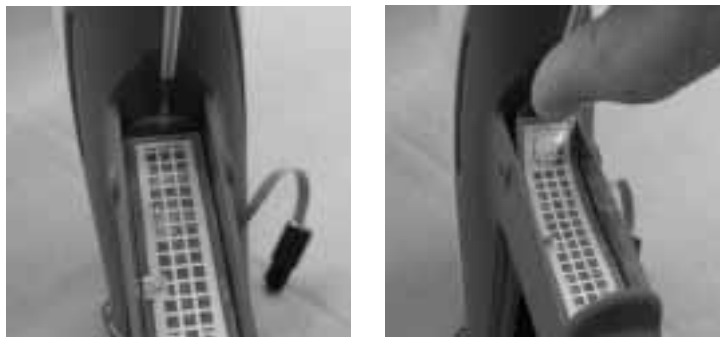
Bild 6-8 Demontering av avtryckarkontakt från handtaget
