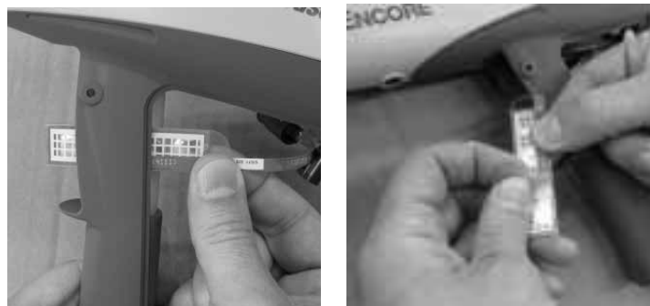
Bild 6-9 Montage av avtryckarkontakt - steg 1 och 2
